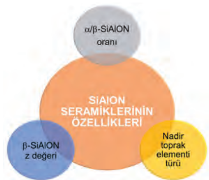
Şekil 2. SiAlON seramiklerinin özelliklerini etkileyen parametreler
